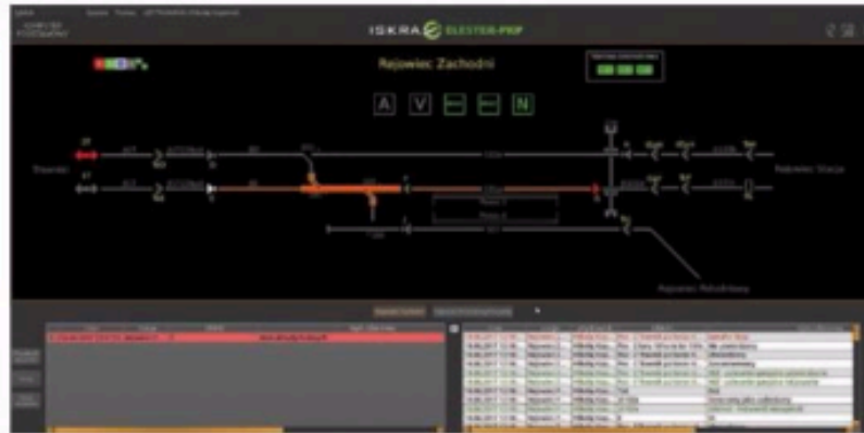
ISKRA komputerowym systemem sterowania ruchem kolejowym. Stanowi przykład całkowicie polskiej myśli technicznej. Na szczególną uwagę zasługuje nowa niespotykana w tej klasy systemach możliwość realizacji jazdy na uzależniony sygnał zastępczy.
